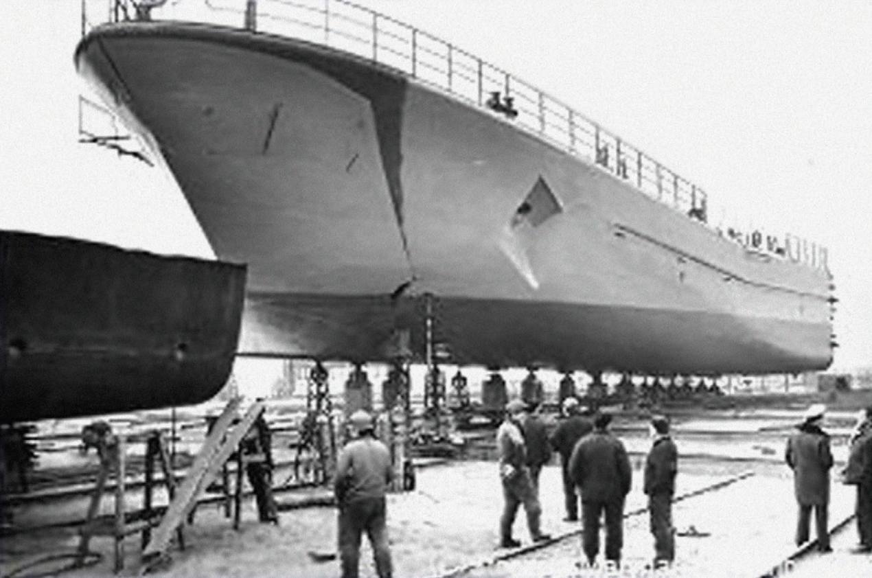
Dziobowa sekcja kadłuba okrętu desantowego budowanego dla Indii. Fot. www.navship.pl
