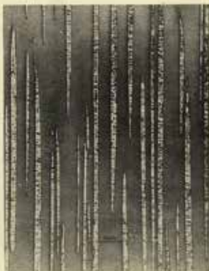
Niob forstærket med lange, parallelle fibre af niob-kar- bid, fibreene er ca. 2 µm i diameter.
