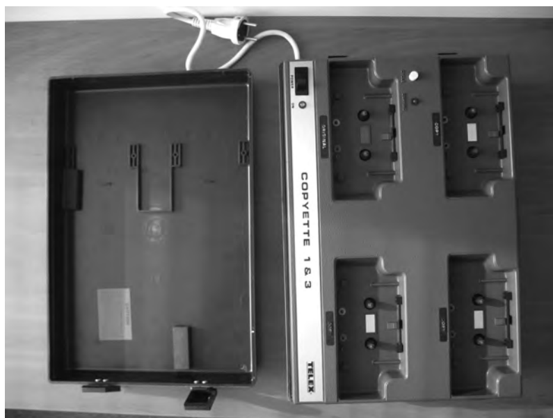
Urządzenie do multiplikowania kaset magnetofonowych (w posiadaniu Macieja Kołaczkowskiego, współpracownika Radia „Solidarność”; fot. autora).
