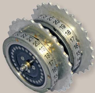
Bębny maszyny szyfrującej Enigma
