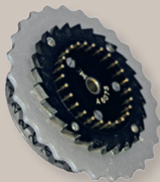
Bębny maszyny szyfrującej Enigma
